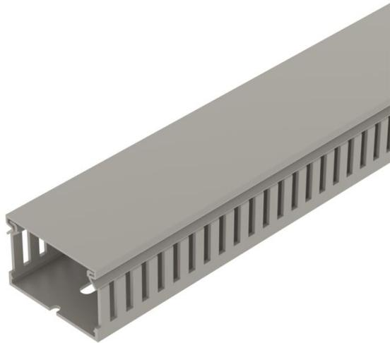
Goulotte de câblage avec couvercle et fond perforé pour la pose horizontale et verticale des câbles et lignes électriques dans l'armoire électrique. La cassure des languettes s'effectue sans outil. Longueurs spéciales sur demande. Testé selon DIN EN 50085-2-3. Socle et couvercle dans le set.
