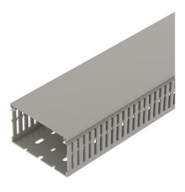
Goulotte de câblage avec couvercle et fond perforé pour la pose horizontale et verticale des câbles et lignes électriques dans l'armoire électrique. La cassure des languettes s'effectue sans outil. Longueurs spéciales sur demande. Testé selon DIN EN 50085-2-3. Socle et couvercle dans le set.
