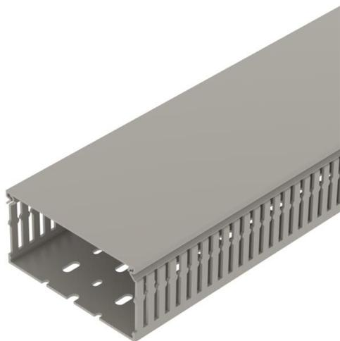
Canale di cablaggio, incl. parte superiore e foratura nel fondo per posa orizzontale e verticale di cavi e linee elettriche nel quadro elettrico. La separazione delle linguette avviene senza utensili. Lunghezze speciali su richiesta. Controllato secondo DIN EN 50085-2-3. Parte inferiore e superiore nel set.
