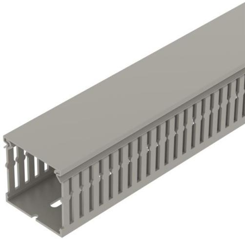
Goulotte de câblage avec couvercle et fond perforé pour la pose horizontale et verticale des câbles et lignes électriques dans l'armoire électrique. La cassure des languettes s'effectue sans outil. Longueurs spéciales sur demande. Testé selon DIN EN 50085-2-3. Socle et couvercle dans le set.
