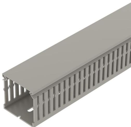
Canale di cablaggio, incl. parte superiore e foratura nel fondo per posa orizzontale e verticale di cavi e linee elettriche nel quadro elettrico. La separazione delle linguette avviene senza utensili. Lunghezze speciali su richiesta. Controllato secondo DIN EN 50085-2-3. Parte inferiore e superiore nel set.
