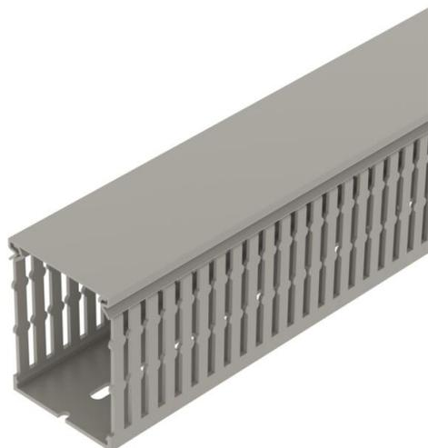
Canale di cablaggio, incl. parte superiore e foratura nel fondo per posa orizzontale e verticale di cavi e linee elettriche nel quadro elettrico. La separazione delle linguette avviene senza utensili. Lunghezze speciali su richiesta. Controllato secondo DIN EN 50085-2-3. Parte inferiore e superiore nel set.
