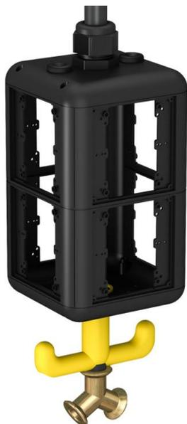
Alloggiamento vuoto con 1 m di tubo da 1/2" e raccordo per tubo flessibile dell'aria compressa da 13 x 3,5 mm e ripartitore a 2 vie da 1/2". Con occhio di aggancio e maniglia a gancio, per il montaggio di dispositivi di azionamento elettrici con divisorio accluso. Senza piastre di copertura.
