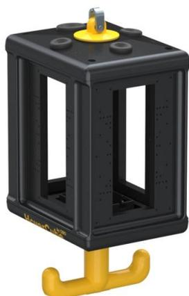
Leergehäuse mit Aufhängeöse und Griffhaken, zum Einbau von elektrischen Betriebsmitteln, mit beigelegter Trennwand. Ohne Abdeckplatten. Zur Versorgung von Arbeitsplätzen in nassen Bereichen. Schutzgrad: IP 44.
