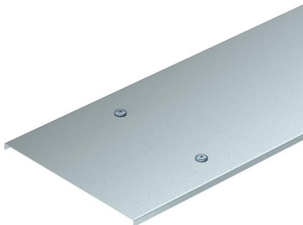
Coperchio per passerelle a grande portata con altezza del bordo pari a 200 mm. Nervatura trasversale a partire dalla larghezza di 500 mm. In caso di maggiori carichi di vento il committente deve provvedere misure di sicurezza idonee.
