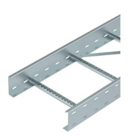
Passerella a grande portata con longherone laterale forato con bordo di 110 mm. Fissaggio di cavi e linee con staffa reggicavo tipo 2056. I giunti lineari tipo WRVL 110 devono essere ordinati separatamente. Schermatura elettromagnetica senza coperchio 10 dB, con coperchio 15 dB.
