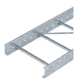
Echelle à câbles longue portée d'une hauteur latérale de 110 mm, avec longeron perforé. Fixation des câbles et de tubes avec bride rapide de type 2056.
