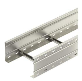
Passerella a grande portata con longherone laterale forato con bordo di 160 mm. Fissaggio di cavi e linee con staffa reggicavo tipo 2056. I giunti lineari tipo WRV 160 devono essere ordinati separatamente. Schermatura elettromagnetica senza coperchio 10 dB, con coperchio 15 dB.
