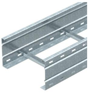
Passerella a grande portata con longherone laterale forato con 160 mm di altezza laterale. Fissaggio di cavi e linee con staffa reggicavo tipo 2056. I giunti lineari tipo WRV 160 devono essere ordinati separatamente. Schermatura elettromagnetica senza coperchio 10 dB, con coperchio 15 dB.
