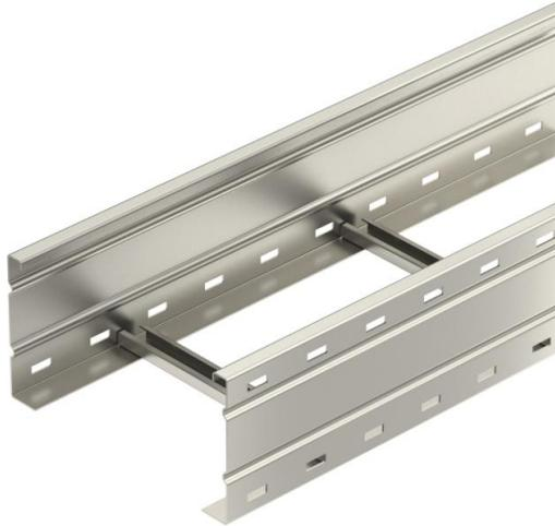
Échelle à câbles longue portée avec longeron perforé d'une hauteur latérale de 160 mm. Fixation des câbles et de tubes avec bride rapide de type 2056. Les raccords droits WRV 160 doivent être commandés séparément en quantités requises. Atténuation magnétique du blindage sans couvercle 10 dB, avec couvercle 15 dB.
