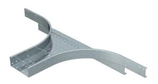
Dérivation à monter pour installation horizontale. Pour tous les chemins de câbles longue portée d'une hauteur latérale de 110 mm. Nous recommandons de prévoir des supports supplémentaires au niveau des pièces de forme pour une plus grande stabilité.
