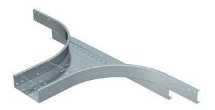
Derivazione laterale per l'impiego orizzontale. Per tutte le passerelle a grande portata con altezza del bordo pari a 110 mm. Per una maggiore stabilità sarebbero necessari maggiori supporti nell'area degli
