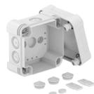
Boîtier de dérivation pour le raccordement de câbles et conduits en intérieur et en extérieurs protégés. Forme carrée avec entrées défonçables. Convient pour le montage au mur / au plafond avec possibilité de fixation extérieure, de fixation intérieure ou de montage sur les dômes d'angle. Particulièrement résistant aux chocs avec IK09. Couvercle avec fermeture rapide, plombable. Fabriqué à partir de matériaux sans halogène et résistants aux UV.
