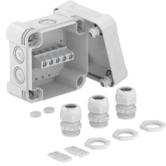
Scatola di derivazione con morsettiera per il collegamento di cavi e linee in ambienti interni e ambienti esterni. Forma quadrata con inserti di deviazione. Adatta per il montaggio su pareti e soffitti con la possibilità di fissaggio esterno e interno o il montaggio su sezioni angolari. Particolarmente resistente agli urti con IK09. Coperchio con chiusura rapida, piombabile. Costruito con materiali privi di alogeni e resistenti agli UV.
