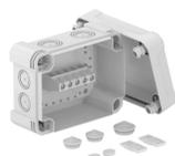
Scatola di derivazione con morsetti per il collegamento di cavi e linee in ambienti interni e ambienti esterni. Forma rettangolare con inserti di deviazione. Adatta per il montaggio su pareti e soffitti con la possibilità di fissaggio esterno e interno o il montaggio su sezioni angolari. Particolarmente resistente agli urti con IK09. Coperchio con chiusura rapida, piombabile. Costruito con materiali privi di alogeni e resistenti agli UV.
