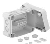
Kabelabzweigkasten mit Klemmleiste zum Verbinden von Kabeln und Leitungen im Innen- und Außenbereich. Rechteckige Form mit Ausschlageinführungen. Geeignet für die Wand-/ Deckenmontage mit der Möglichkeit zur Außenbefestigung, Innenbefestigung oder Montage über die Eckdome. Besonders schlagfest mit IK09. Deckel mit Schnellverschluss, plombierbar. Hergestellt aus halogenfreien und UV-resistenten Materialien.
