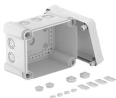
Scatola di derivazione per il collegamento di cavi e linee in ambienti interni e ambienti esterni. Forma rettangolare con inserti di deviazione. Adatta per il montaggio su pareti e soffitti con la possibilità di fissaggio esterno e interno o il montaggio su sezioni angolari. Particolarmente resistente agli urti con IK09. Coperchio con chiusura rapida, plombabile. Costruito con materiali privi di alogeni e resistenti agli UV.
