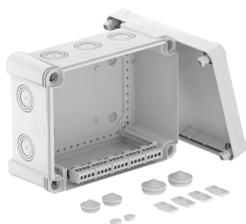
Scatola di derivazione con morsettiere per il collegamento di cavi e linee in ambienti interni e ambienti esterni. Forma rettangolare con inserti di deviazione. Adatta per il montaggio su pareti e soffitti con la possibilità di fissaggio esterno e interno o il montaggio su sezioni angolari. Particolarmente resistente agli urti con IK09. Coperchio con chiusura rapida, piombabile. Costruito con materiali privi di alogeni e resistenti agli UV. Incluso morsetto.
