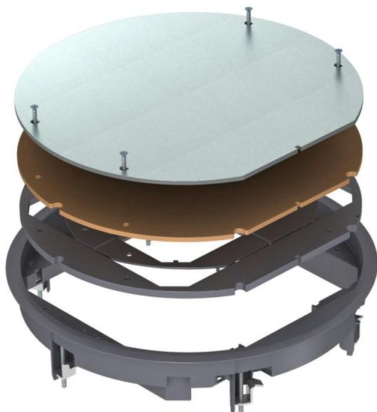
Inserto della scatola di derivazione per la chiusura cieca di un'apertura di montaggio tonda con dimensione nominale R9 nei sistemi di canali e nei pavimenti doppi o con intercedini in ambienti interni. Con angolare di fissaggio universale. Telaio di protezione moquette in poliammide. Spessore del rivestimento pavimento max 12 mm.
