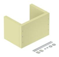
Scarico trazione come misure di supporto efficaci per la posa dei cavi verticale secondo DIN 4102 parte 12. Omologato per tutti i tipi di cavi e sistemi di posa, che vengono montati direttamente su pareti massicce. Classe di mantenimento funzionale da E30 a E90. Alloggiamento vuoto per il riempimento individuale con schiuma antincendio PYROSIT® NG e/o blocchi di materiale espanso PYRO-PLUG® Block, incl. set di montaggio ed etichetta di contrassegno.
