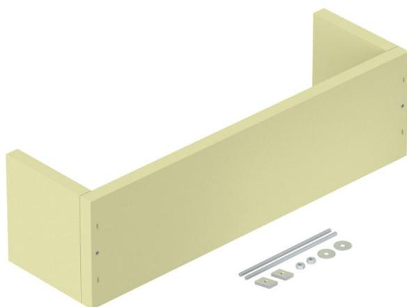
Décharge de traction comme mesure efficace pour pose de câbles verticale selon la norme DIN 4102 partie 12. Homologation pour tous les types de câble et systèmes de pose qui sont posés directement sur les parois massives. Classes de maintien en fonction E30 à E90. Boîtier vide pour remplissage individuel avec la mousse coupe-feu PYROSIT® NG et/ou les blocs de mousse PYROPLUG® Block, y compris kit de montage et plaque d'identification.
