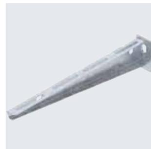
Fissaggio della mensola al profilato a U a partire dalla larghezza di 400 mm con vite a testa esagonale attraverso entrambi i longheroni del profilato. Si prega di impiegare i distanziatori adatti allo scopo.
