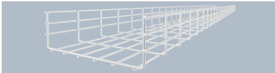
Passerella grigliata composta da fili in acciaio saldati a punto con bordo di altezza pari a 105 mm. Rivestita con Plascoat NG-10, privo di alogeni.
