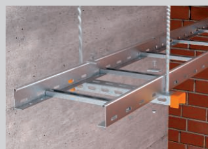
Montage sur profilé transversal avec pièce de serrage, vis à tête bombée et grandes rondelles.
