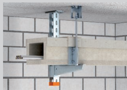
Montage comme goulotte en E avec sécurisation supplémentaire par tiges filetées.
