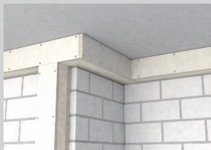
Cheminement flexible des gouttes grâce à des pièces moulées réalisables à souhait.
