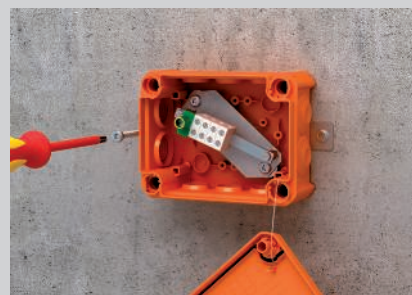
Montage rapide du couvercle par rotation à 90° des vis d'angle.
