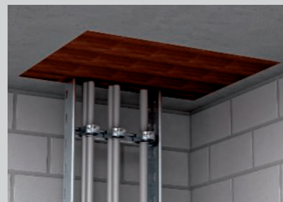
Mise en place bien serrés de blocs pour calfeutrer une traversée de dalle
