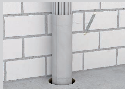
Fixation du bandage avec fil de bobinage.
