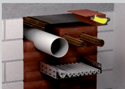
Passaggio di tubi incombustibili senza ulteriori misure.
