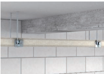
Abgehängte Montage an den Verbindungselementen.
