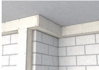
Flexible Kanalführung durch individuell herstellbare Formteile.
